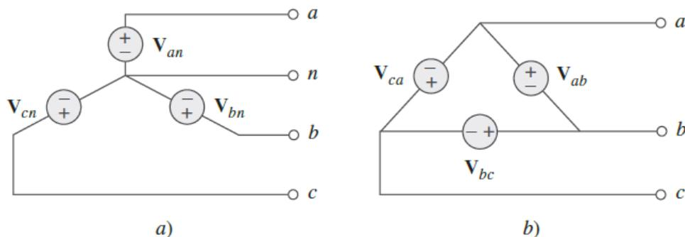
Si las fuentes se encuentran conectadas en 'Y', ósea,  $V_{an}, V_{bn}, V_{cn}$  se encuentran respectivamente entre las líneas a, b, c y la línea neutra. Estas tensiones se llaman tensiones de fase. Esto es sistema trifásico balanceado de voltajes, y se tiene que:
