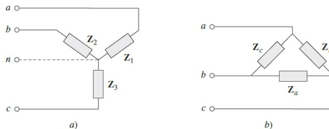
En dicha practica se debe comprobar la que la magnitud de las tensiones de línea  $V_L$  es  $\sqrt{3}$  veces la magnitud de las tensiones de fase  $V_F$ .
