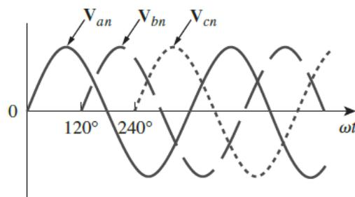
Un sistema trifásico habitual consta de tres fuentes de tensión conectadas a cargas mediante tres o cuatro conductores. Un sistema trifásico equivale a tres circuitos monofásicos. Dichas fuentes se pueden conectar en 'Y' o el ' $\Delta$ '.
